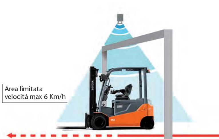
Utilizzando la tecnologia RFID (Identificazione a radio frequenza) quando il mezzo transita attraverso il varco, oltre all'interazione con il mezzo, il sistema Zoning interagisce con l'ambiente circostante, in base alle esigenze specifiche del cliente (apertura porte, accensione luci, etc.).
